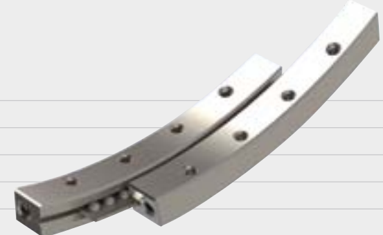
Guide "Gonio" a rulli incrociati tipo RGB , equipaggiate con sfere o rulli cilindrici. Consentono movimenti di precisione curvilinei con minimo attrito e senza gioco. Diametro rulli 2 e 3 mm. Ampiezza di rotazione circa \pm 10^\circ .
