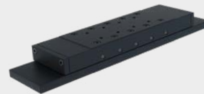
Tavola con protezione antipolvere RTNG (acciaio/ghisa). Corsa 10-250 mm. Uno spazio molto ridotto tra la superficie inferiore e superiore della slitta evita che polvere e sporizia si insinuino all'interno delle guide lineari. Capacità massima di carico 35.100 N.
