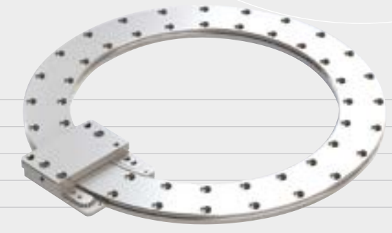
Guide curve senza attrito tipo RPM (in acciaio anti-corrosione), permettono di realizzare un movimento curvilineo di precisione, ad attrito quasi-zero, con precarico. Diametro sfere 3 mm. Ampiezza di rotazione max 360°.
