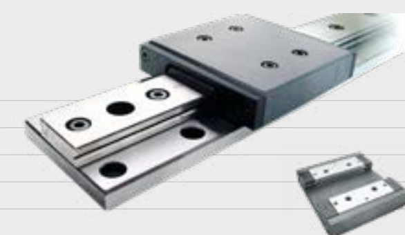
Guida lineare di precisione per corse illimitate costituita da: piastra base tipo UT , rotaia di guida con piste laterali tipo DS e cursore tipo US per unità a ricircolo UK (a sfere) e tipo UR (a rulli).
