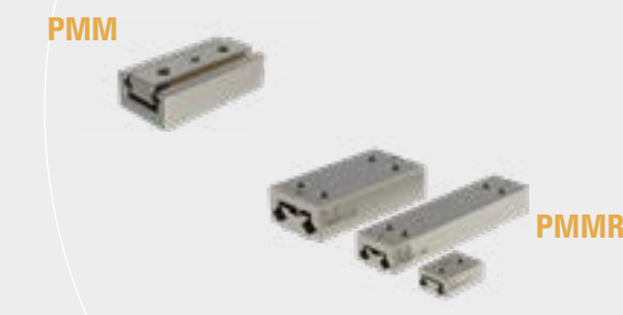
Per applicazioni in ambienti ridotti: micro slitte tipo PMM (a pieno riempimento di sfere) e PMMR (a rulli incrociati). Lunghezza di corsa 5-70 mm, disponibili in 3 taglie dimensionali. Peso 2-80 grammi. Per movimenti rapidi e precisi in spazi ristretti. La serie PMMR a rulli incrociati è caratterizzata da elevata rigidità e lunga durata.
