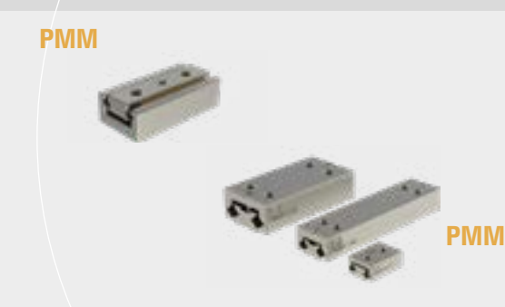
Pour les encombrement réduits, les micro-tables PMM (avec billes) et PMMR (avec rouleaux). Course de 5 à 70 mm et 3 dimensions disponibles. Poids de 2 à 80 grammes. Pour des mouvements rapides et précis dans des espaces réduits. Le type PMMR inclut des cages à rouleaux croisés pour une plus grande rigidité et une plus longue durée de vie.
