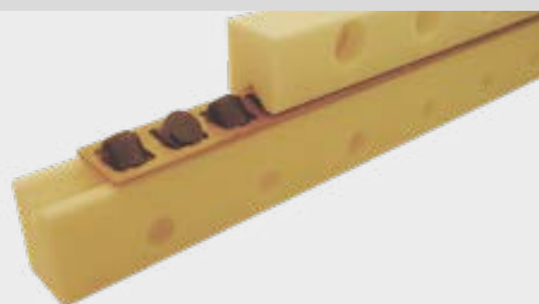
Guidage linéaire entièrement en matériau céramique ( CR ), un matériau idéal pour les applications nécessitant des mouvements rapides, un poids réduite ou dans un environnement extrême. Sont communément utilisés les matériaux céramiques tels que le nitrure de silicium ( Si3N4 ), l'oxyde de zirconium ( ZrO2 ) ou l'oxyde d'aluminium ( Al2O3 ).
