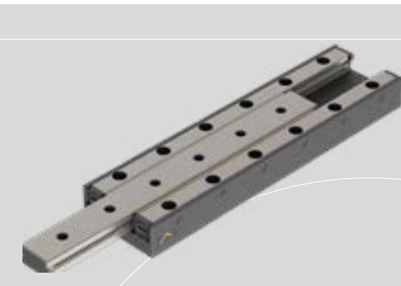
Mesa de rolos cruzados de perfil baixo tipo RTS (aço). Comprimento do curso 12-130 mm. Capacidade máxima de carga 3.672 N.
