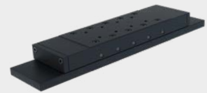
Mesa de rolamento protegida contra poeira tipo RTNG (aço / ferro fundido). Um intervalo de ar muito apertado entre os membros deslizantes superior e inferior evita que poeira, fragmentos e cavacos entrem no interior dos rolamentos lineares. Comprimento do curso 10-250 mm. Capacidade máxima de carga 35.100 N.
