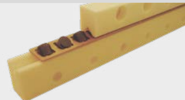
Rolamentos lineares cerâmicos completos tipo CR para qualquer aplicação que procure alcançar, maior velocidade, reduzir o peso total ou para elementos extremamente duros. Os materiais cerâmicos comumente utilizados são o nitrito de silício (Si3N4), o óxido de zircônia (ZrO2) ou o óxido de alumínio (Al2O3). Campos de uso: microscopia eletrônica, semicondutor e médico.
