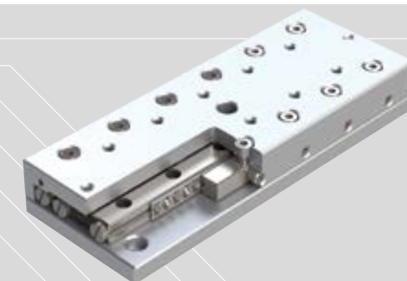
Mesa de rolos cruzados tipo RT (aço / ferro fundido) e modelo leve RTA (alumínio). Comprimento do curso 10-950 mm. Capacidade máxima de carga 71.550 N.
