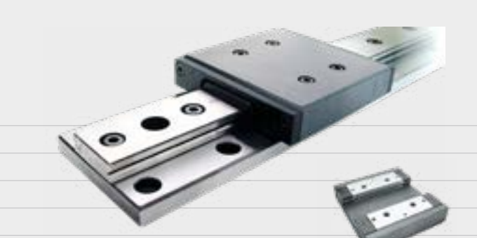
Mesa de rolamento protegida contra poeira tipo RTNG (aço / ferro fundido). Um intervalo de ar muito apertado entre os membros deslizantes superior e inferior evita que poeira, fragmentos e cavacos entrem no interior dos rolamentos lineares. Comprimento do curso 10-250 mm. Capacidade máxima de carga 35.100 N.
