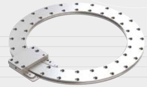
Anillos sin fricción tipo RPM (acero inoxidable). Permiten al usuario un movimiento curvado de precisión, casi libre de fricción y precargado. Diámetro de 3 mm. Gama de rotación máx. 360°.
