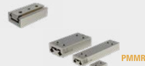
Corredera micro tipo PMM y PMMR . Longitud de carrera 5 - 70mm y en 3 tamaños disponibles. Peso 2-80 gramos. Para un movimiento rápido y preciso en espacios estrechos. Los PMMR incluyen rodamientos de rodillos cruzados para una alta rigidez y una vida útil más larga.
