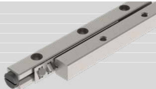
Rodillo cruzado tipo RSD , equipado con rodillos cilíndricos o bolas. Diámetros del rodillo 1.5 - 24 mm.
