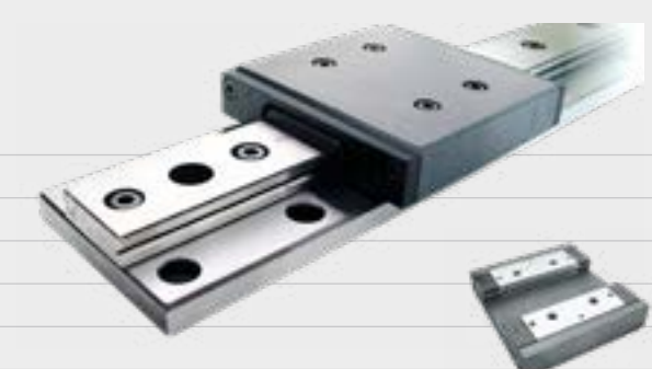
Rodamiento lineal de precisión para movimientos ilimitados, compuesto por: placa de base tipo UT , carril de carril doble tipo DS y tipo de corredera US para unidades de recirculación tipo UK (tipo bola) y tipo UR (tipo rodillo).
