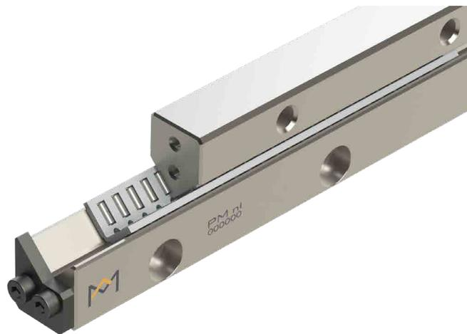
Längsführungen Typ N/O und M/V sind für besonders hohe Belastungen geeignet und mit einem Nadelrollenkäfig ausgestattet. Die Nadelrollenabstände des Käfigs sind eng angeordnet, dadurch wird eine extrem hohe Steifigkeit und Genauigkeit erreicht.
