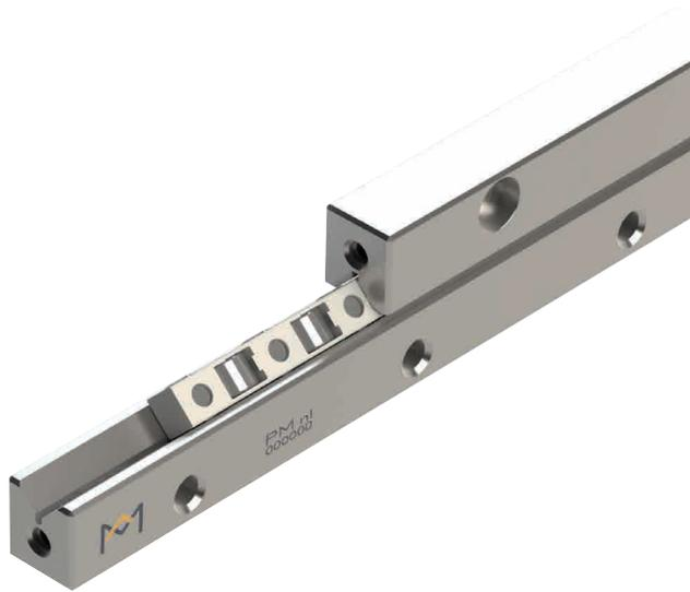
Längsführungen des Typs RSDE sind eine Weiterentwicklung der Standardführung RSD. Durch die tiefere V-Nut und größere Kontaktfläche hat Typ RSDE eine höhere Tragzahl und größere Steifigkeit bei gleicher Dimension wie die Längsführung RSD. RSDE-Längsführungen werden meist bei hochdynamischen Anwendungen eingesetzt, wo hohe Geschwindigkeiten und Beschleunigungen verlangt werden bei gleichzeitig präziser Ablaufgenauigkeit und höchster Qualität.
