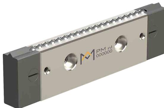
*Umlaufkörper UK sind einreihige Kugellager für niedrige bis mittlere Lasten. Für höhere Tragzahlen und verbesserte Steifigkeit bieten wir Kreuzrollen-Umlaufeinheiten UR an. Die Einheiten sind für den Einsatz in jeder räumlichen Ausrichtung konzipiert. Die maßgeschneiderte Rückführung bietet extrem ruhige Laufeigenschaften.*
