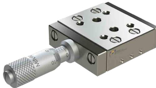
*Unsere manuellen Positioniertische Typ MT mit Einbaumikrometer sind kreuzrollengelagert und geeignet für höchste Positionieranforderungen bei Bewegungsaufgaben im Bereich von Mikroskopie und Inspektionsanwendungen. Diese Tische sind spielfrei und gewährleisten damit eine hohe Wiederholungsgenauigkeit.*
