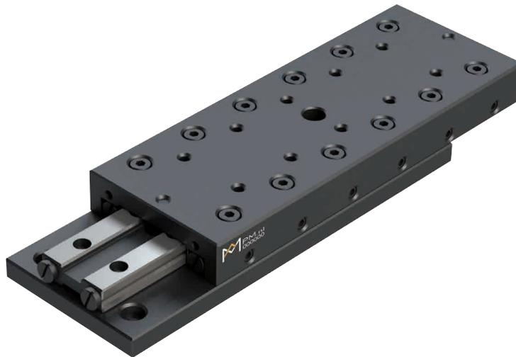
Präzisions-Rolltische Typ RTN und RTL sind einbaufertige, einachsige Komponenten für begrenzte und präzise Linear-Verfahrwege. Die Rolltische mit Standard Kreuzrollen-Längsführungen, ab Werk spielfrei vorgespannt, haben einen leichten und reibungsarmen Lauf. Auf den Basisrolltischen ist eine doppelseitige Schiene montiert, dadurch sind Parallelitätsfehler ausgeschlossen.
