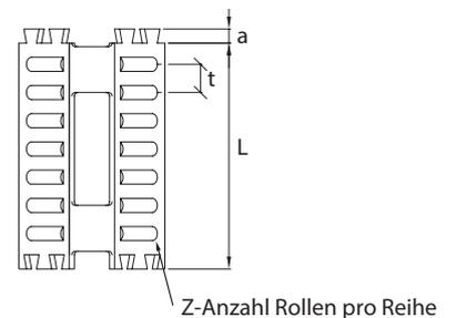
Schwalbenschwanznuten an beiden Seiten zur einfachen Verbindung beliebig vieler Elemente.
