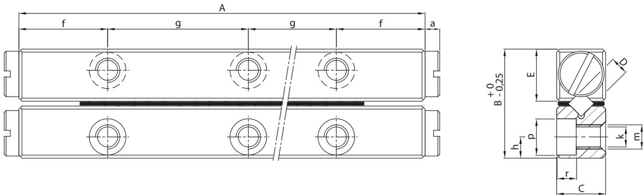
Ein Satz besteht aus: 4 Schienen + 2 Rollenkäfige + 8 Endstücke montiert
