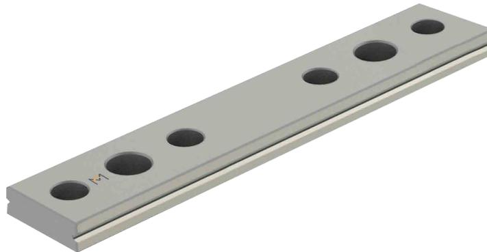
*DS Doppelseitige Führungsschienen sind konzipiert für den Einsatz mit RSD-Längsführungen mit Käfigen für raumsparende Lösungen, ebenso für den Einsatz mit Umlenkörpern UK und UR für lange Hübe und niedrige Bauhöhen. Die Laufbahnen sind beidseitig präzisionsgeschliffen für hochgenaue Linearbewegungen. Dies eliminiert Fehler bei Installation und Bearbeitung im Vergleich zur Verwendung zweier Einzelschienen.*
