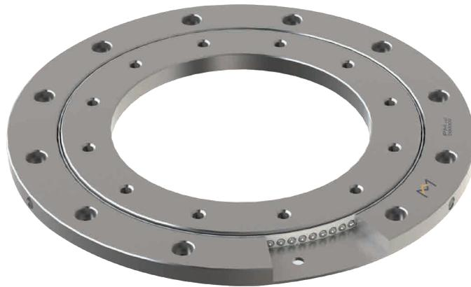
Das Präzisionstischlager FMB besteht aus zwei durchgehärteten Standardlagerstahlringen, einem Kunststoffkäfig Teflon und hochpräzisen Stahlkugeln. Die speziell entwickelten Laufbahnen erhöhen die Tragfähigkeit und Steifigkeit bei der Momentbelastung und garantieren eine hohe Präzision, eine längere Lebensdauer und einen sehr niedrigen Reibungskoeffizienten. Sie sind besonders geeignet für Anwendungen mit mittlerer Belastung, z.B. in optischen Geräten und Computertomografen.
