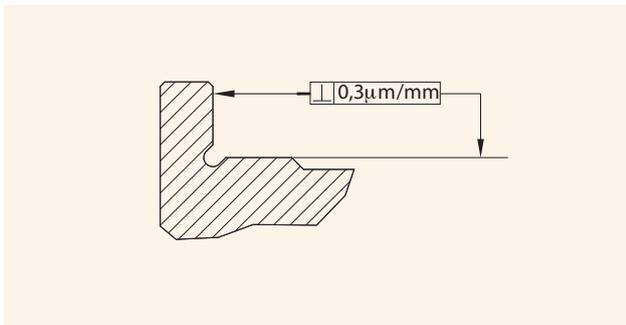
Die Toleranzen der Längsführungen im belasteten und unbelasteten Zustand sollten folgende Werte nicht überschreiten:
