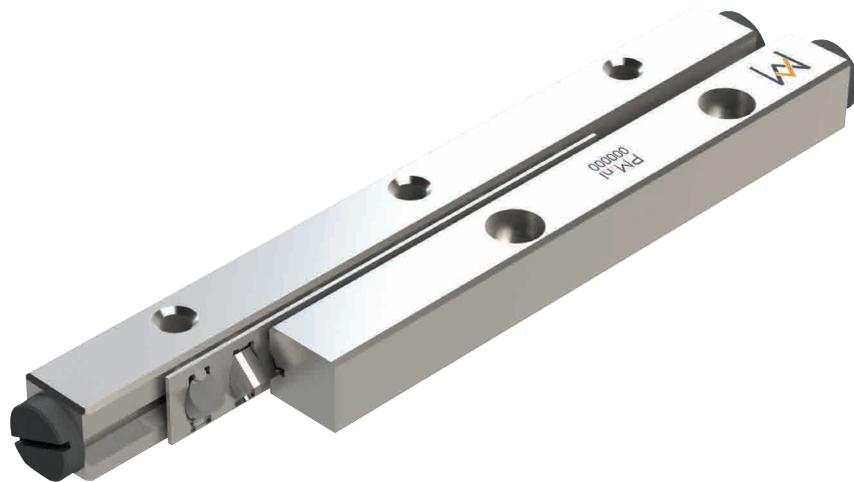
*Längsführungen des Typs RSD sind kompakte Führungen für präzise Längsbewegungen mit hoher Genauigkeit und ausgezeichneter Zuverlässigkeit. In Abhängigkeit von der Belastbarkeit können Kugel- oder Kreuzrollenkäfige eingesetzt werden. Kreuzrollenkäfige sind mit Zylinderrollen ausgestattet. Durch die langjährige Erfahrung mit den RSD-Längsführungen sind diese weltweit Standard in Hightech-Anwendungen geworden, mit bester Qualität und minimalen Kosten.*
