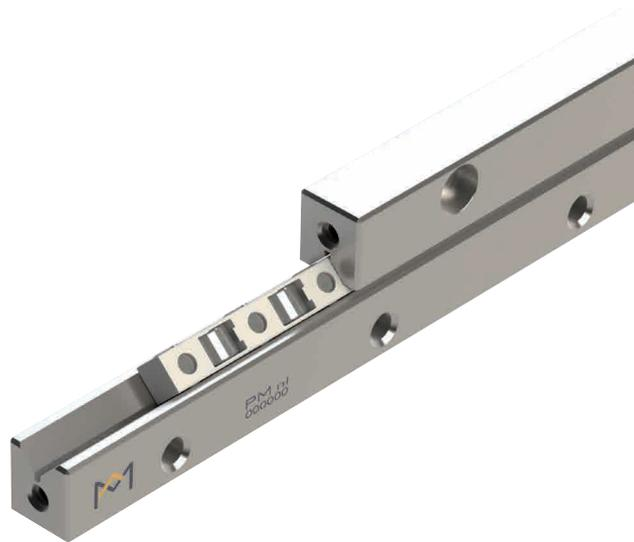
*Kompakt, Hochbelastbar und Zuverlässig. Die RNG Baureihe in Größe 4 und 6 mm ist eine Weiterentwicklung der bewährten RSDE Längsführung. Damit profitieren Sie von Vorteilen wie deutlich höheren Tragzahlen und doppelter Steifigkeit, jedoch kompakteren Einbauabmessungen durch eine Optimierung der Innengeometrie der Laufbahn. Rollenkäfige sind in POM und PEEK lieferbar. Mit dieser Ergänzung macht PM Bewährtes noch besser.*
