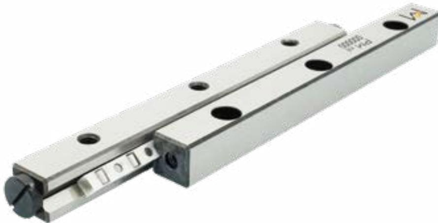
Längsführungen des Typs RSDE sind eine Weiterentwicklung der Standardführung RSD. Durch die tiefere V-Nut und größere Kontaktfläche hat Typ RSDE eine höhere Tragzahl und größere Steifigkeit bei gleicher Dimension wie die Längsführung RSD. RSDE-Längsführungen werden meist bei hochdynamischen Anwendungen eingesetzt, wo hohe Geschwindigkeiten und Beschleunigungen verlangt werden bei gleichzeitig präziser Ablaufgenauigkeit und höchster Qualität.
