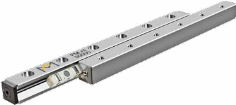
*Kompakt, Hochbelastbar und Zuverlässig. Die RNG Baureihe in Größe 4 und 6 mm ist eine Weiterentwicklung der bewährten RSDE Längsführung. Damit profitieren Sie von Vorteilen wie deutlich höheren Tragzahlen und doppelter Steifigkeit, jedoch kompakteren Einbauabmessungen durch eine Optimierung der Innengeometrie der Laufbahn. Rollenkäfige sind in POM und PEEK lieferbar. Mit dieser Ergänzung macht PM Bewährtes noch besser.*
