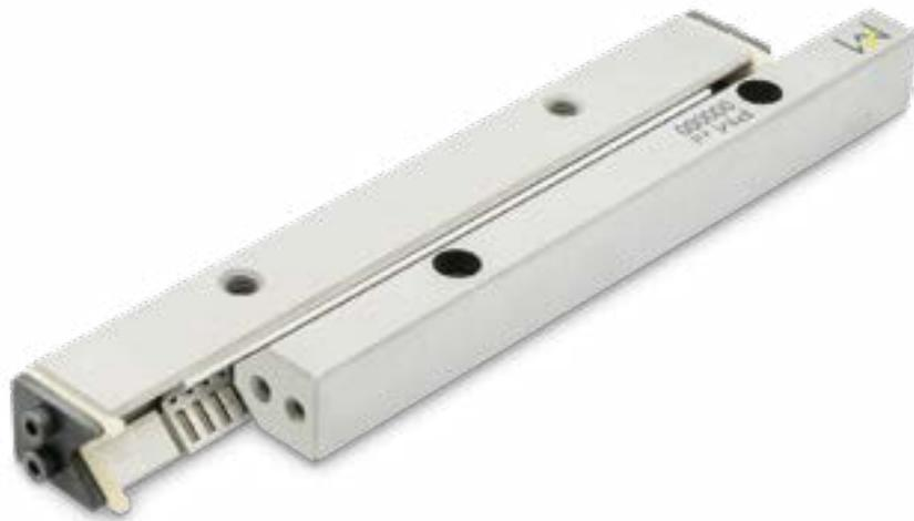
Längsführungen Typ N/O und M/V sind für besonders hohe Belastungen geeignet und mit einem Nadelrollenkäfig ausgestattet. Die Nadelrollenabstände des Käfigs sind eng angeordnet, dadurch wird eine extrem hohe Steifigkeit und Genauigkeit erreicht.
